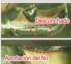
② Resistencia al desgaste deficiente
